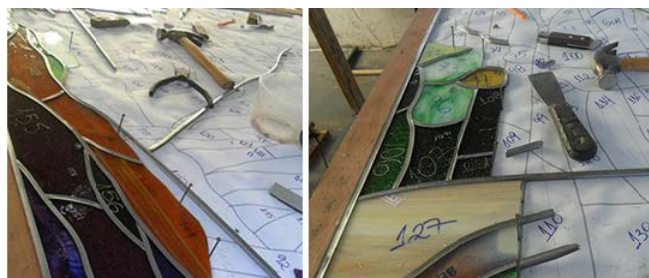
Figura 9 – Processo de solda dos vitrais. - Fonte: http://www.castelvitrais.com.br/tecnicas
