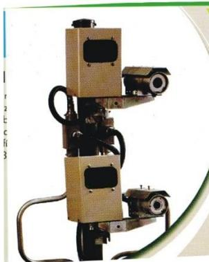
Figura 9: Medidor fixo de velocidade “Pardal”.
