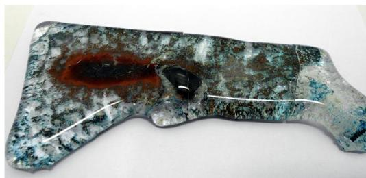
Figura 1 – Amostra vítrea pigmentada com cobre
