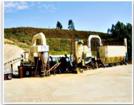
Figura 4: Equipamentos para Dessorção Térmica Móvel (ESSENCIS, 2012).
