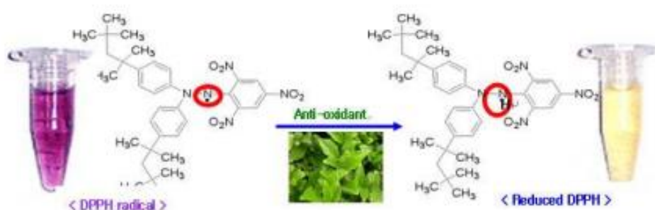
Figura 12. – Exemplo de mudança de cor do radical DPPH após reagir com antioxidante. [24]
