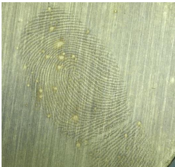
Figura 11: Exemplo de revelação de impressão digital latente a partir do vapor de cianoacrilato associado a imersão em uma solução de Gun Blue e aquecida a 200°C (GIRELLI, 2015)
