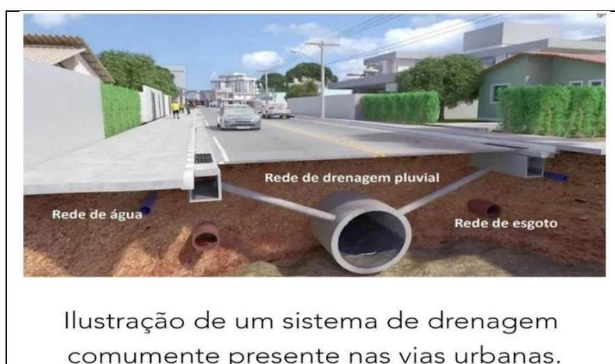
**Figura 2 – Sistema de drenagem nas vias urbanas**
