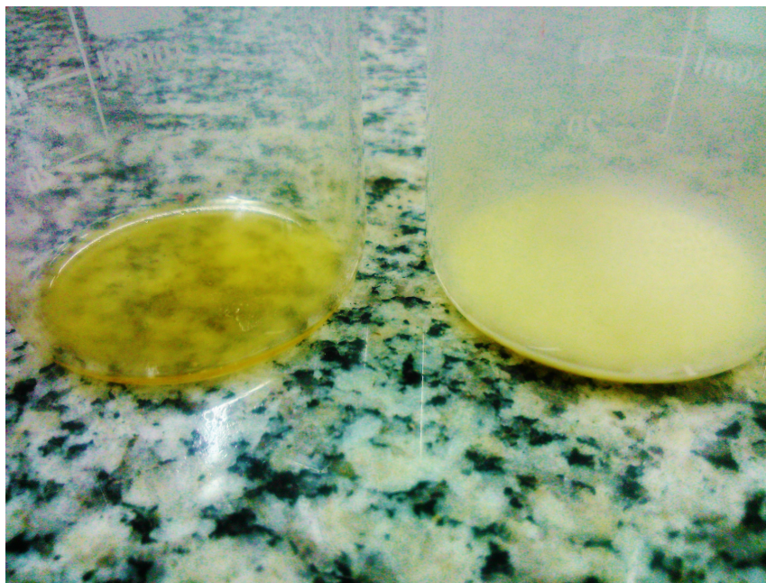
Figura 6: porção lipídica extraída do chocolate através da adição de propanona (à direita) e éter de petróleo (à esquerda)
