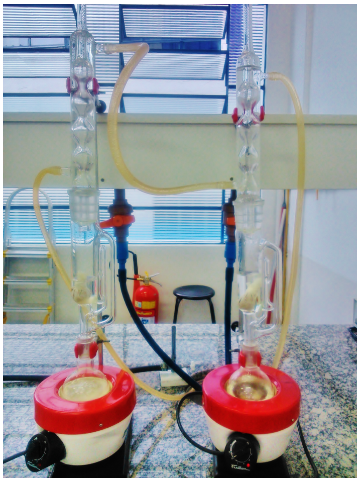
Figura 4: extração simultânea de lipídeos do chocolate pelo método Soxhlet, com diferentes solventes
