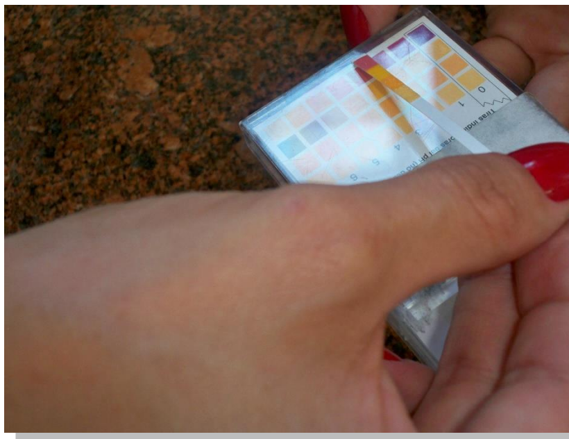
Fig. 4 – Análise do pH e constatação da solução acidificada pela oxidação do enxofre
