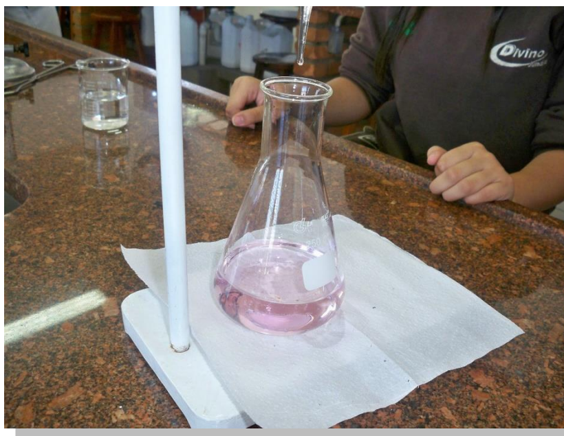
Fig. 5 – Titulação da solução ácida com hidróxido de sódio e fenolftaleína
