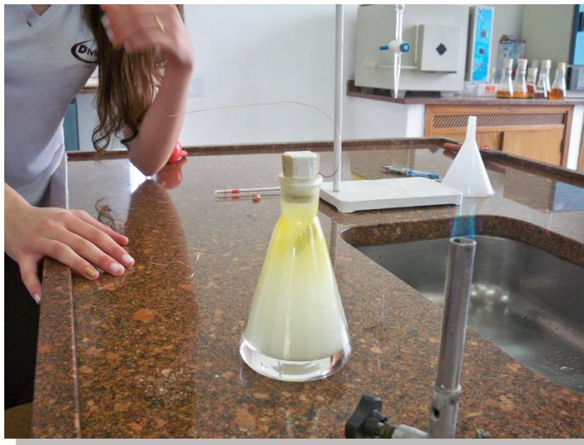
Fig. 3 – síntese do ácido sulfúrico, simulando processo da chuva ácida.
