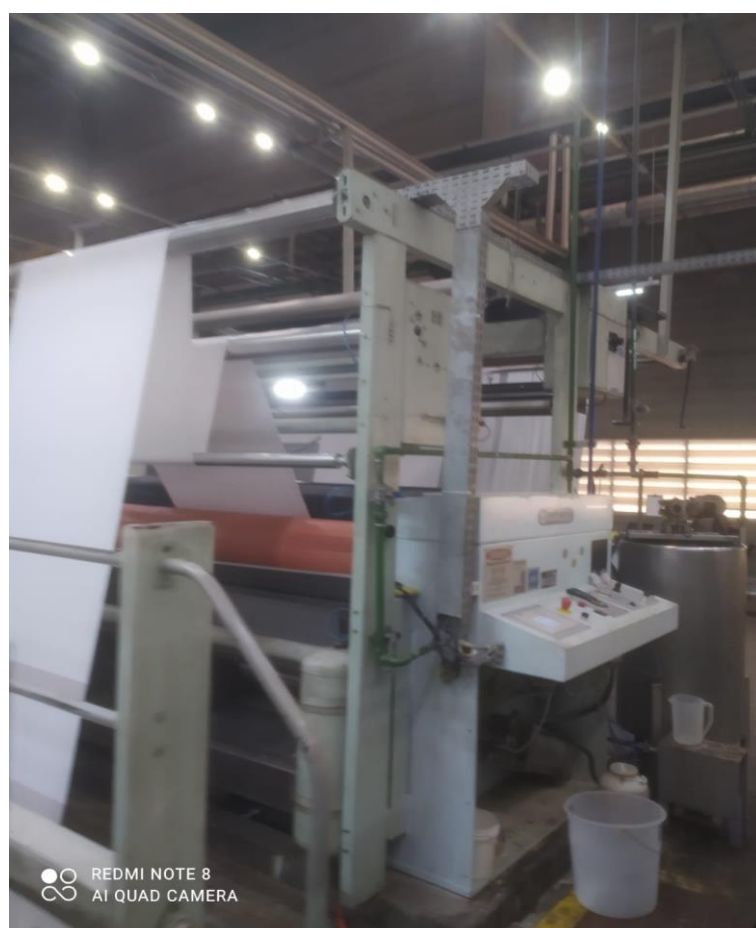
Figura 12 - Entrada e ajuste de tensão ramas Fonte: Autores
