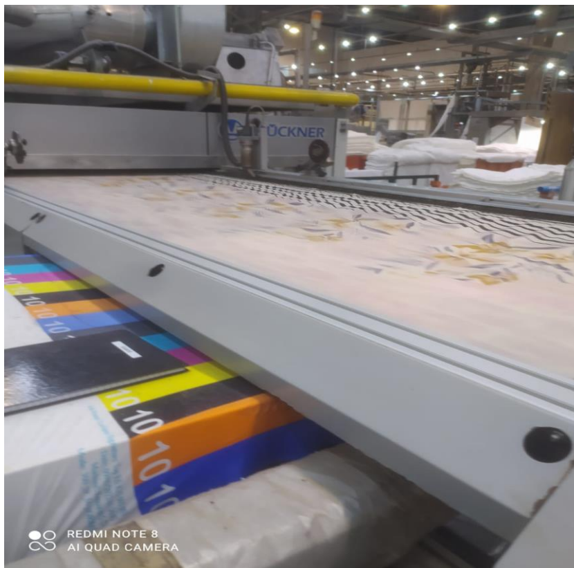
Figura 13 - Ponto de agulhamento e entrada para demais processos Fonte: Autores
