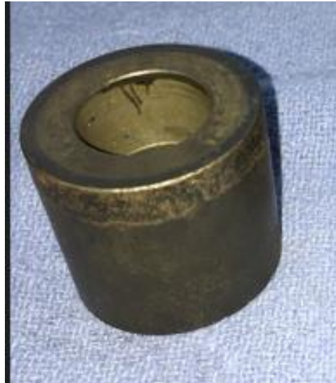
Figura 18 – Matriz com desgaste Fonte: thyssenkrupp
