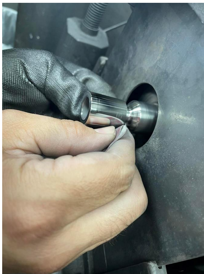
Figura 16 - execução polimento Fonte: thyssenkrupp
