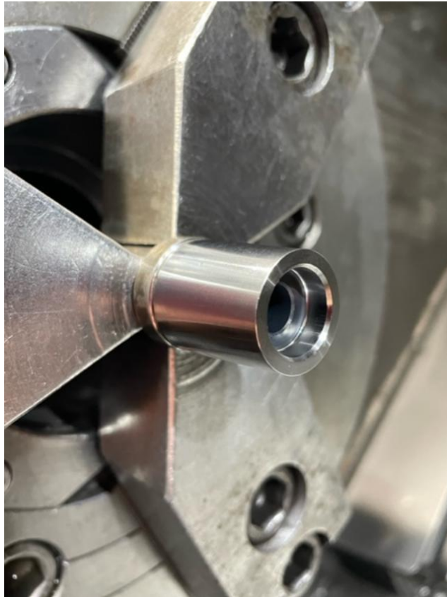
Figura 14 - Matriz já realizado acabamento Fonte: thyssenkrupp
