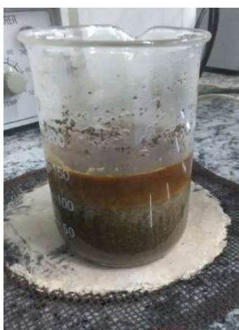
Figura 11 – Sistema de extração sólido-líquido após aquecimento
