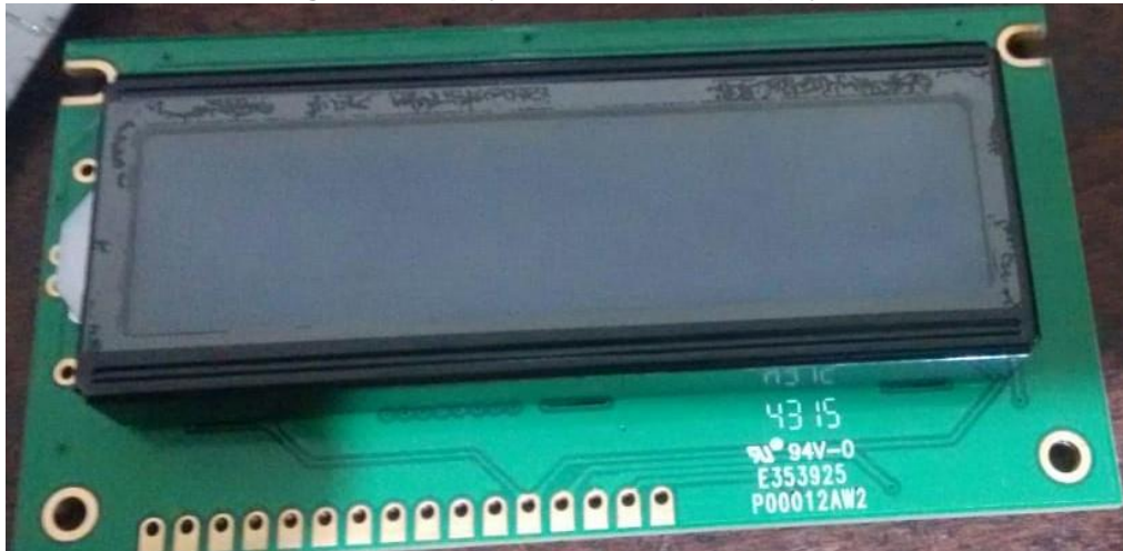
Figura 7 - Display de LCD utilizado no projeto
