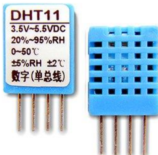
Figura 19 - Sensor de umidade e temperatura
