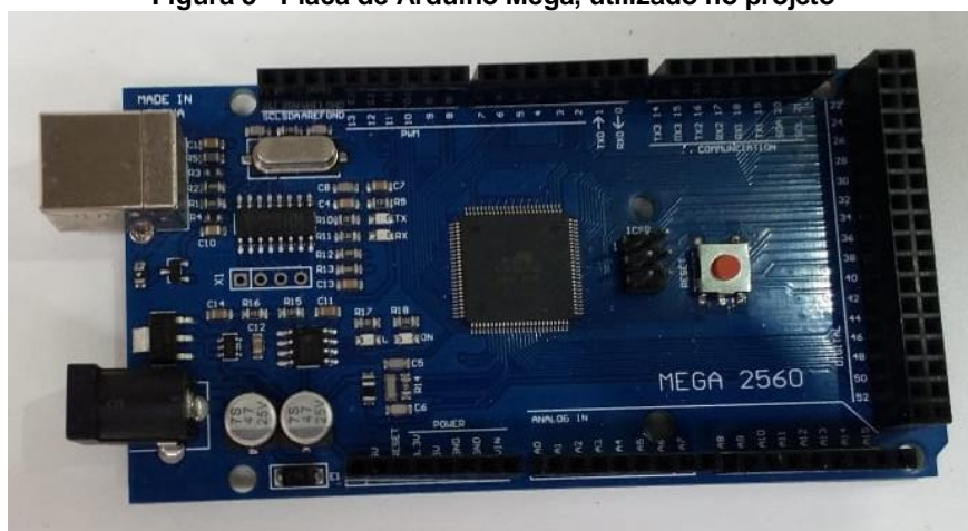
Figura 5 - Placa de Arduíno Mega, utilizado no projeto
