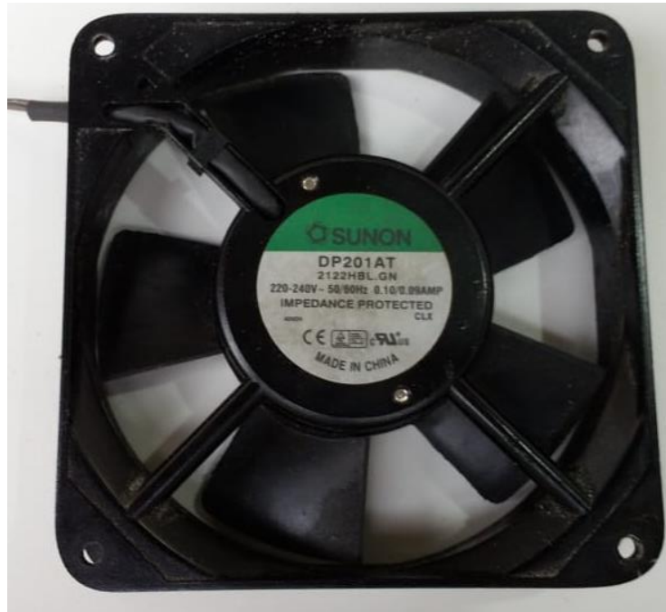
Figura 15 - Cooler utilizado na incubadora
