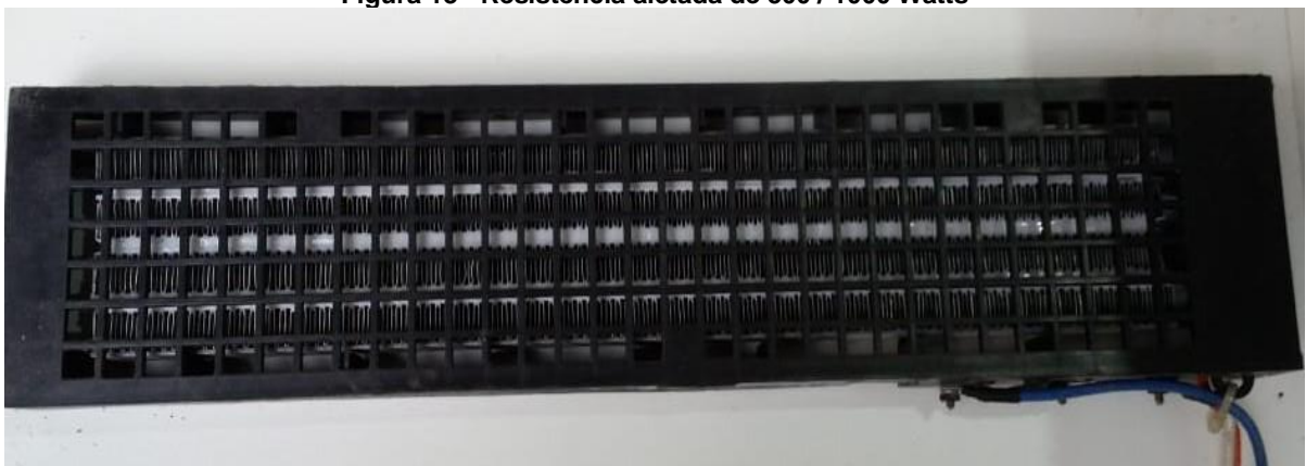
Figura 13 - Resistência aletada de 500 / 1000 Watts
