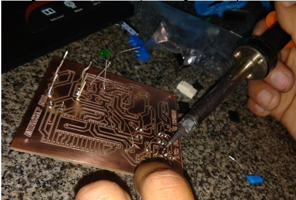
Figura 37 - Processo de inserção e soldagem dos componentes.
