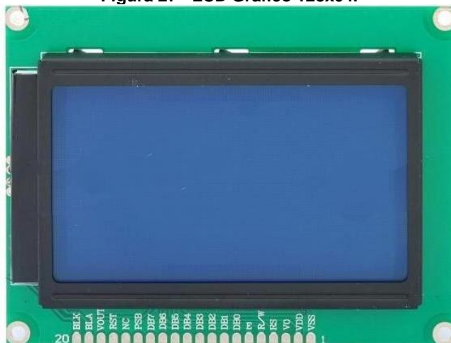
Figura 27 - LCD Gráfico 128x64.
