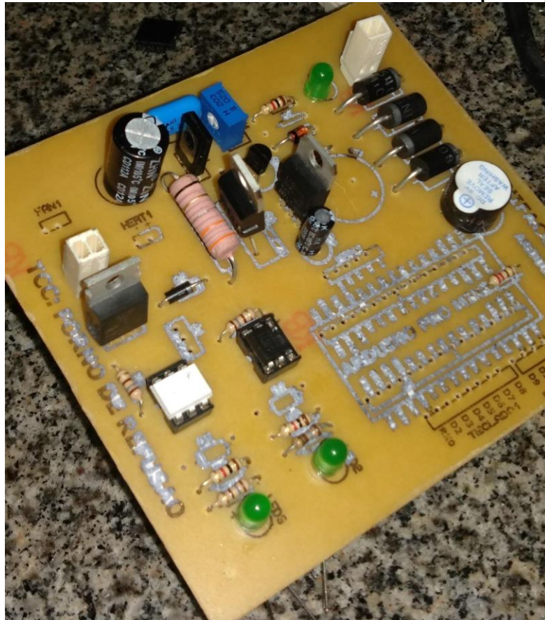
Figura 38 - Placa controladora do forno de refusão montada e pronta para uso.
