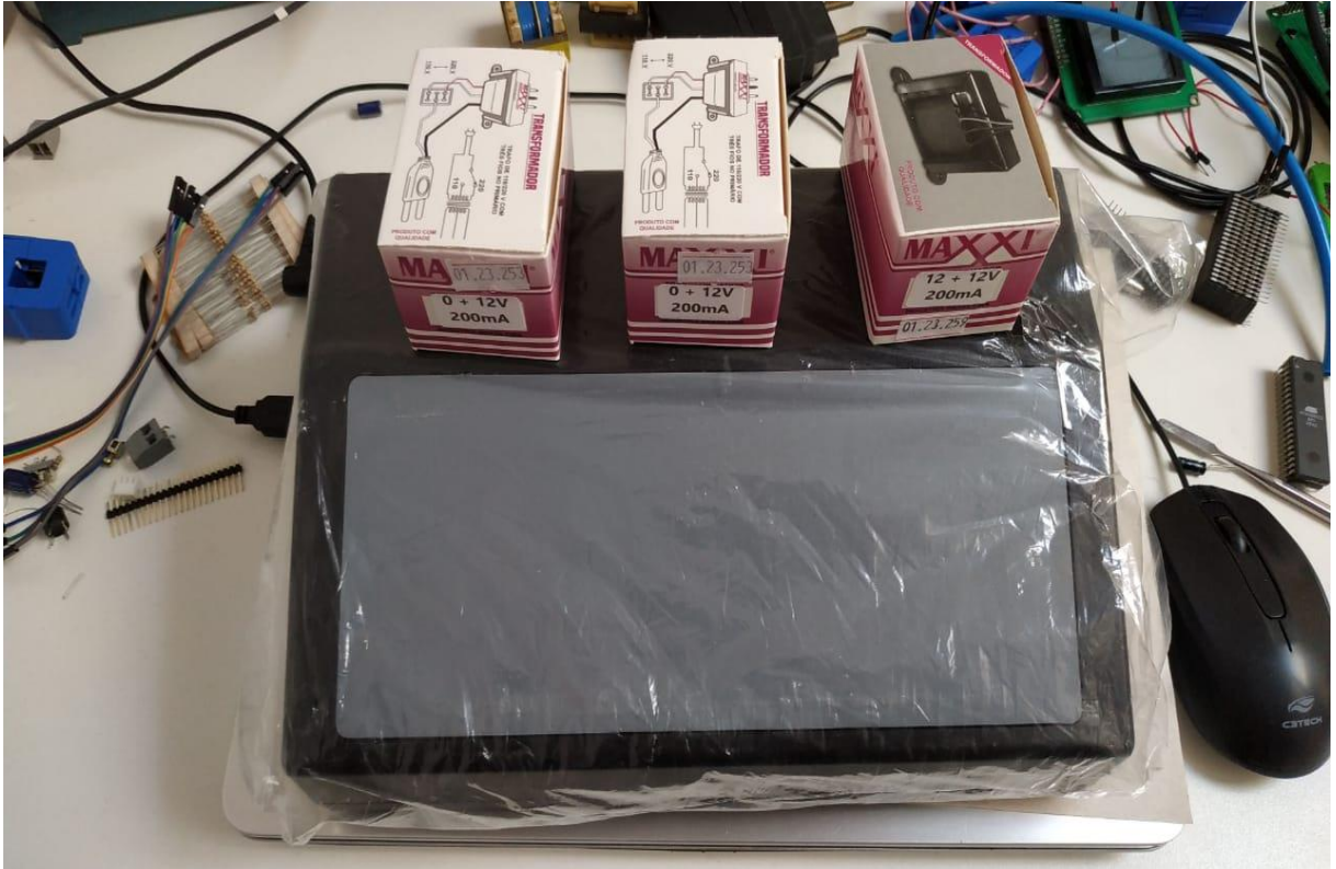
Figura 13 - Display LCD 128X64 (patola plástica, 3 transformadores comprados para montagem)
