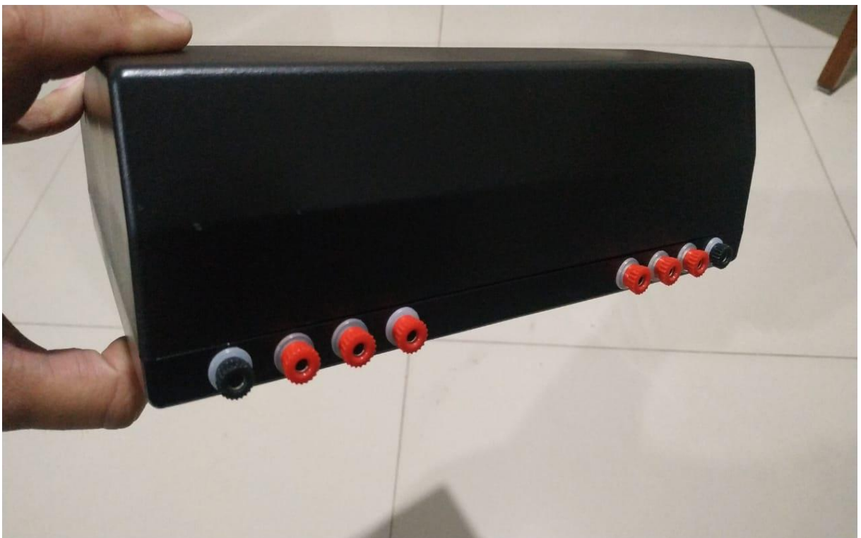
Figura 17 - Instalação dos bornes de ligação
