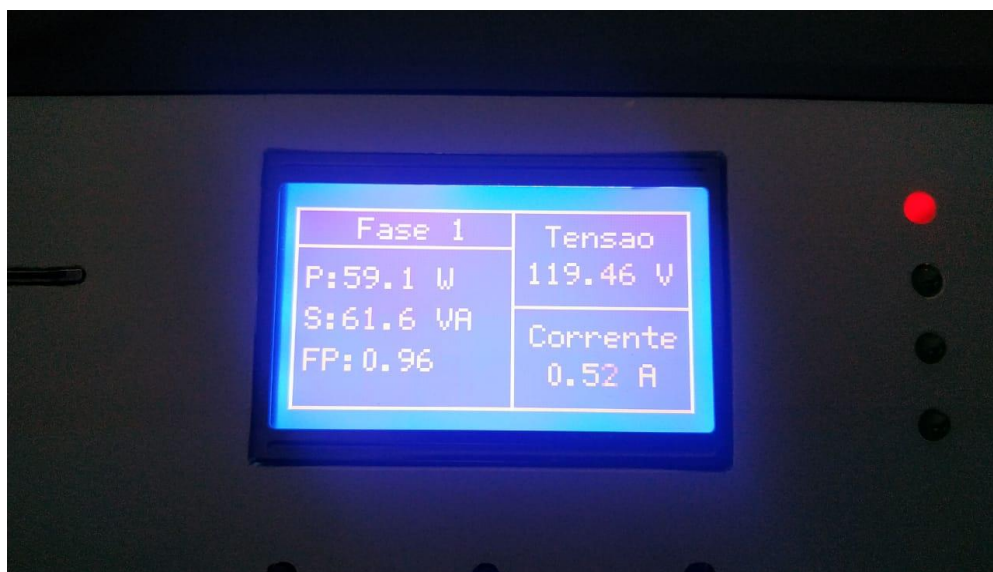
Figura 20 - Realizando a leitura das grandezas físicas
