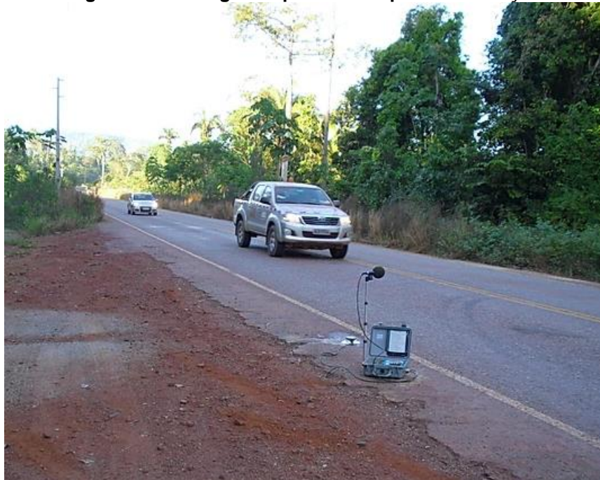
Figura 10 -Sismógrafo típico e exemplo de instalação
