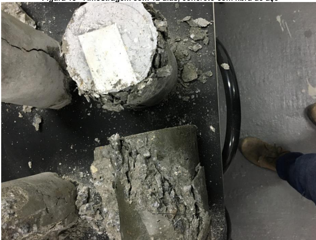
Figura 15 - Amostragem com 12 dias, concreto com fibra de aço
