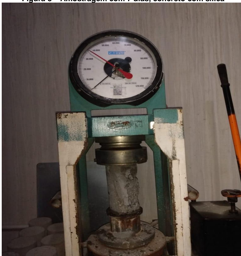
Figura 9 - Amostragem com 7 dias, concreto com sílica
