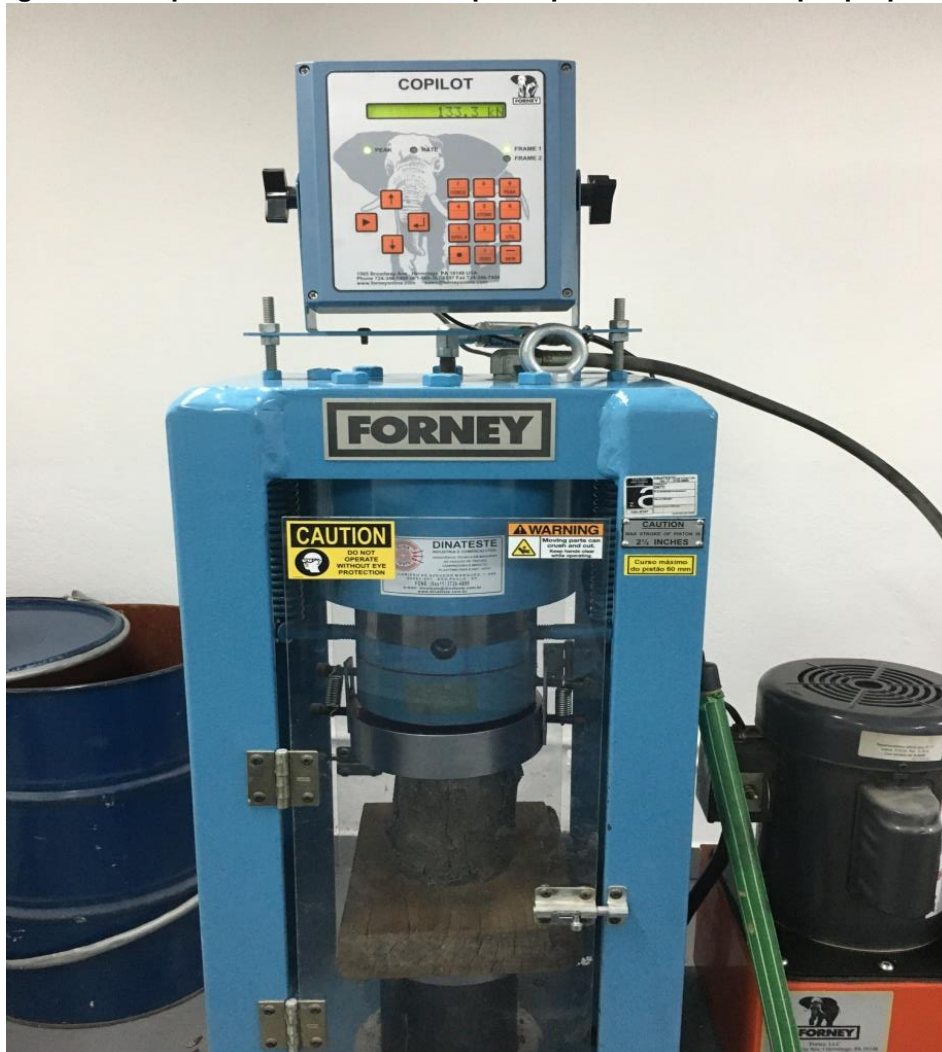
Figura 17 - Ruptura com 3 dias do corpo de prova com fibra de polipropileno
