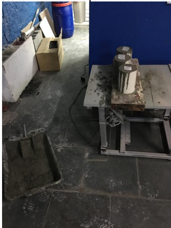
Figura 12 Uso da mesa vibratória para o adensamento do concreto
