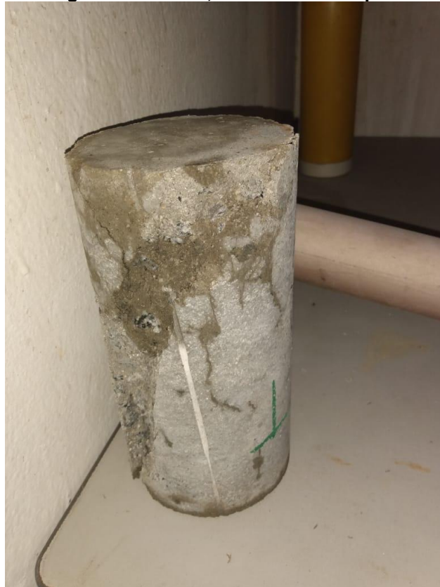
Figura 10 - Amostragem com 7 dias, concreto com ruptura correta em cone
