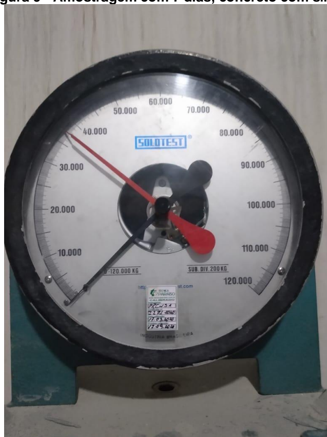
Figura 9 - Amostragem com 7 dias, concreto com sílica
