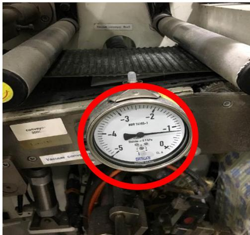
**Figura 16 - Manômetro sem tampa**
