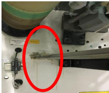
**Figura 18 - Vazamento**
