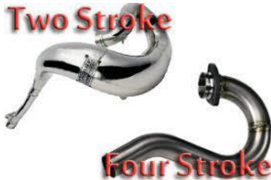
Figura 04 – Escapamentos de motores 2 tempos ( Two Stroke ) e 4 tempos ( Four Stroke )
