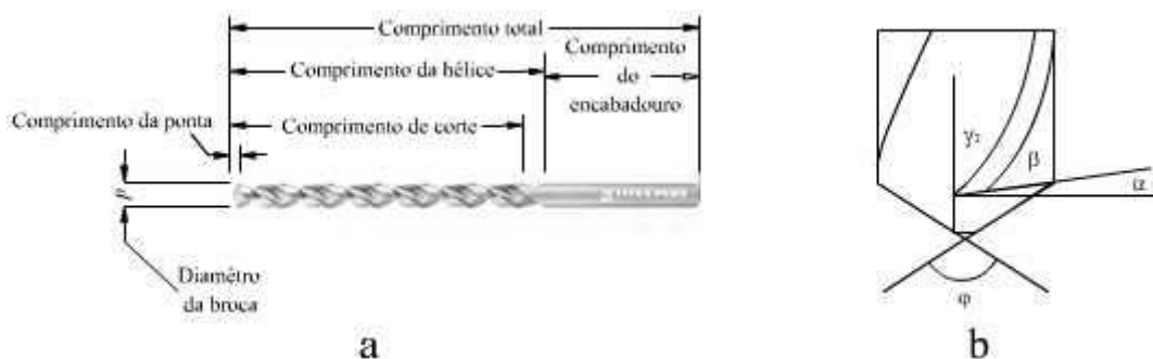
Figura 4ª - Divisão das partes da broca
