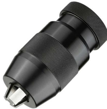
Figura 48 - Mandril de aperto rápido Fonte: (Retirada da apostila de elementos de máquina ESSEL)
