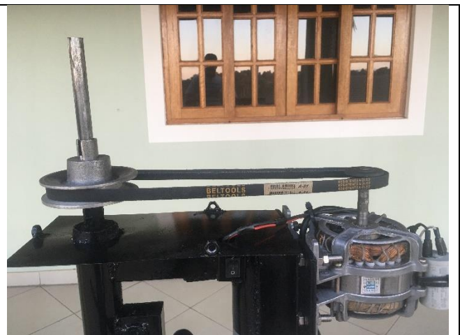
Figura 70 - Sistema de transmissão do Protótipo
