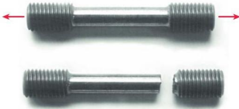
Figura 3 - Fratura em material frágil Fonte: (NORTON, 2013, p. 34)
