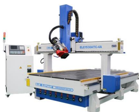
Figura 02 – ATC CNC Router + 4 eixos Fonte: ( http://www.elephant-cnc.com acesso 15/03/2021)
