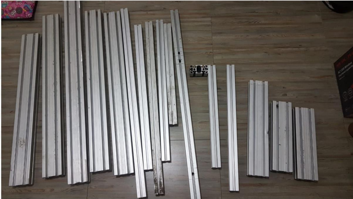
Figura 21 – Perfis em alumínio extrudado (tipo Bosch 45x90 / 40x40)
