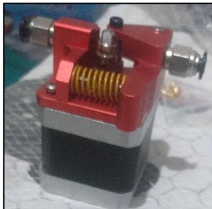
Figura 22 - Extrusora Acoplado ao Motor Nema
