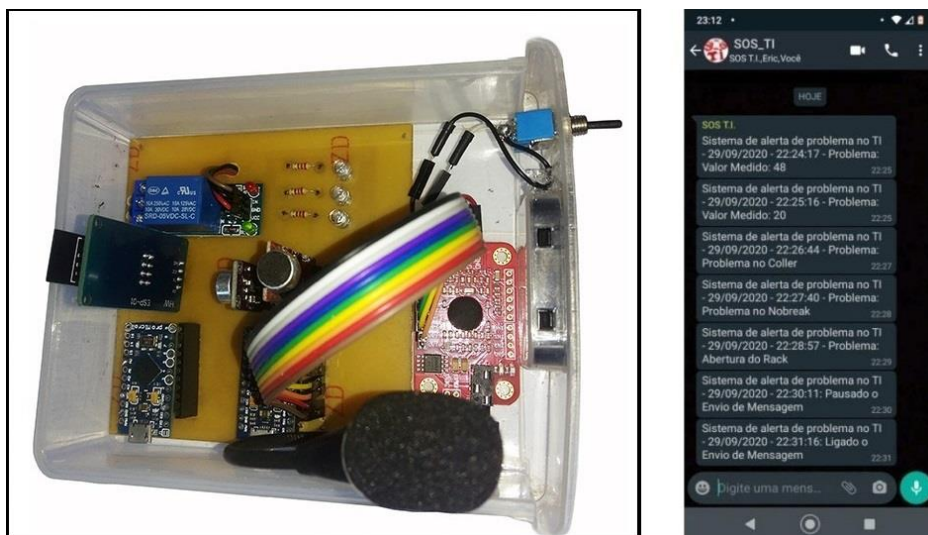
Figura 5: (a) Placa de circuito impressos com os componentes e (b) Mensagens recebidas no aparelho celular
