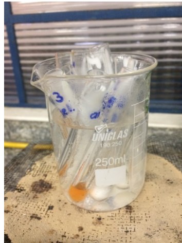
Foto 3: Teste de estresse término mostrando que uma das amostras ficou alaranjada.
