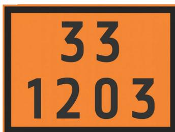
**Figura 12** - Painel de Segurança para Gasolina – Risco 33 – ONU 1203 (Adaptação ABNT NBR 7500/2017)
