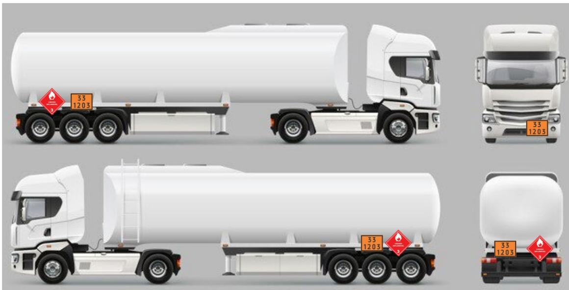
**Figura 14** - Adaptação de rotulagem para transporte da gasolina (ABNT NBR 7500/2017)
