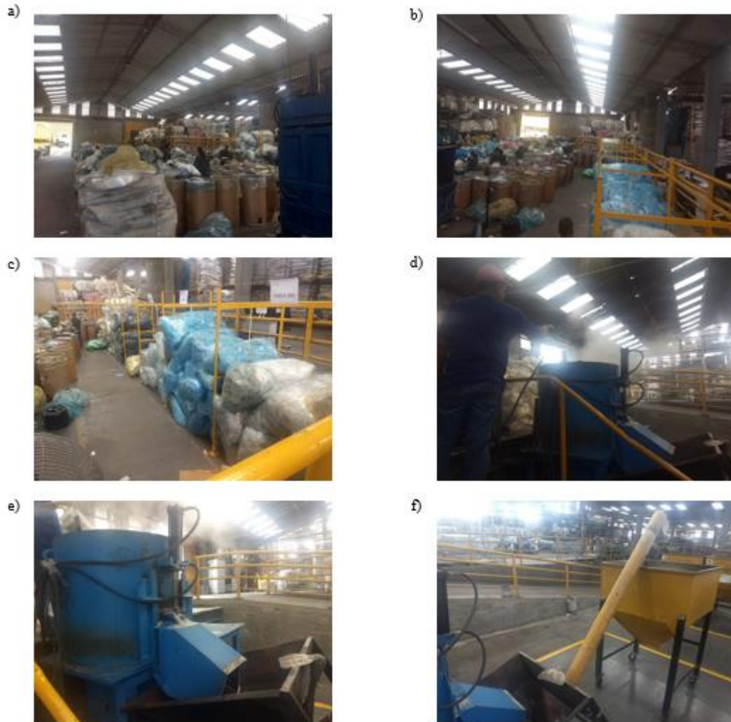
Figura 22: Processamento da Matéria Prima: a) triagem, b) triagem, c) separação por cor, d) lavagem e secagem, e) lavagem e secagem, f) lavagem e secagem.
