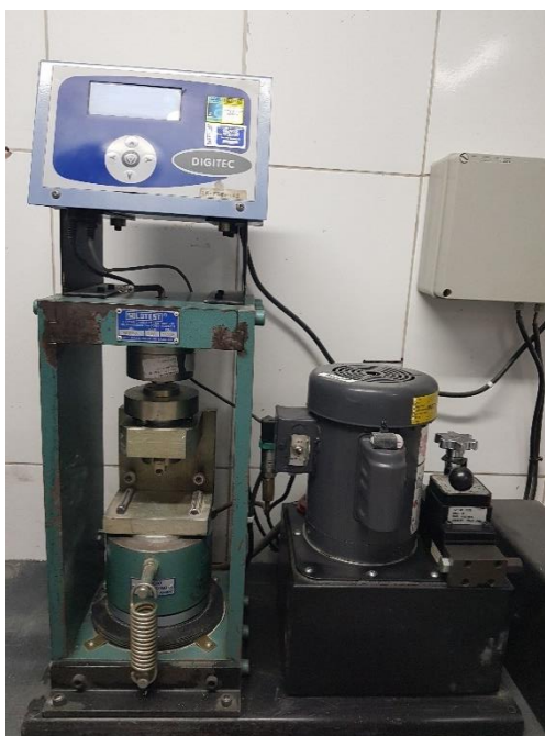
Figura 21 - Equipamento para teste de resistência
