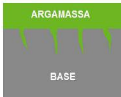
Figura 2 – Ancoragem da argamassa na base
