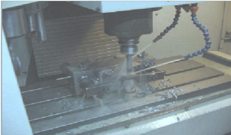
Figura 6 - Furação com utilização de fluido de usinagem Fonte: SUPERTEC Usinagem Técnica Industrial
