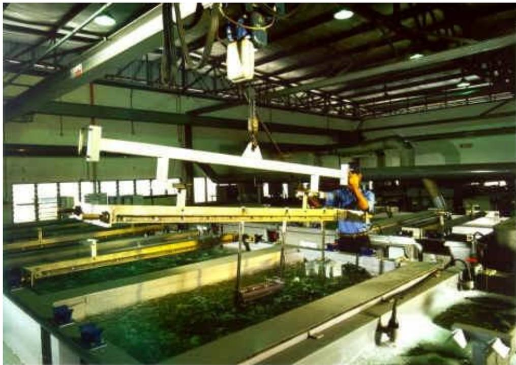
**Figura 3:** Imersão da peça em tanque para decapagem (Disponível em: <https://www.vipsolucoes.com.br/decapagem-acido-cloridrico.html>)
