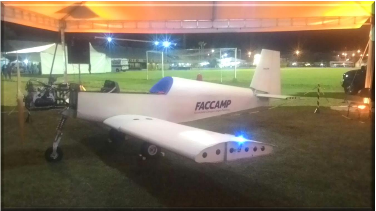
Projeto em desenvolvimento dos alunos do Curso Superior de Tecnologia em Manutenção de Aeronaves. Ultraleve Modelo CH100 Mono Zenith (Projetista Chris Heinz Ano 1970)
