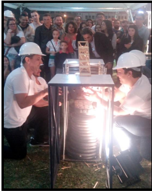
Treliça sendo submetida à ruptura
