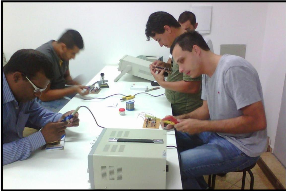
Testes de funcionamento do amplificador de áudio e correção de problemas
